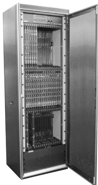
Las opciones de tarjetas para las UCC Modelos 4020 y 4048 incluyen: Controlador de Tráfico del Sistema, Interfaz a consola, Control de Tx/Rx para dos canales, entradas y salidas auxiliares, y patch.
