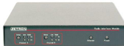
6002 soporta una amplia gama de temperaturas, tiene buena inmunidad a RF, no tiene partes móviles y utiliza un confiable sistema operativo interno. A la misma vez, los SRG's permiten mantenimiento completo remoto utilizando un web browser, que incluye la funcionalidad de poder actualizar el firmware y hacer ajustes de niveles sin tener que ir físicamente al sitio remoto.
